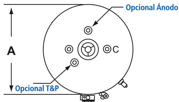
Cuando se pide la válvula T&P superior, el ánodo se mueve a la ubicación de atrás y la ubicación del ánodo queda disponible para la válvula T&P instalada en campo.
